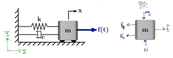
$$M\ddot{x} - F_0 - F_p = f \rightarrow M\ddot{x} + C\dot{x} + kx = f$$
